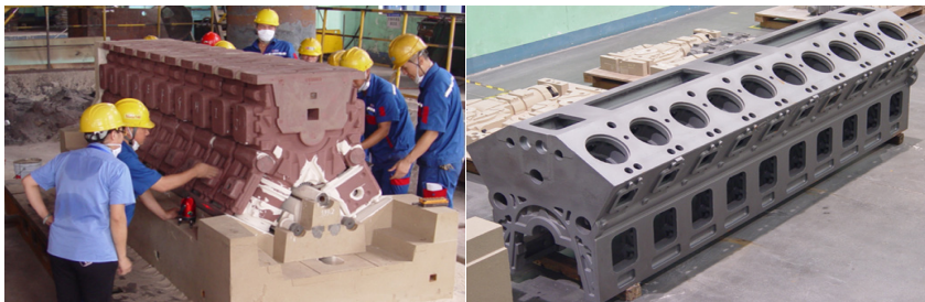
图 1 玉柴 20 缸机体快速铸造（毛坯尺寸 3412 × 1050 × 960，重 4.5 吨）
