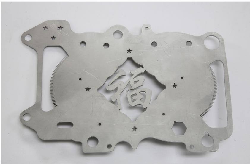
图 2 光纤薄板切割样件
