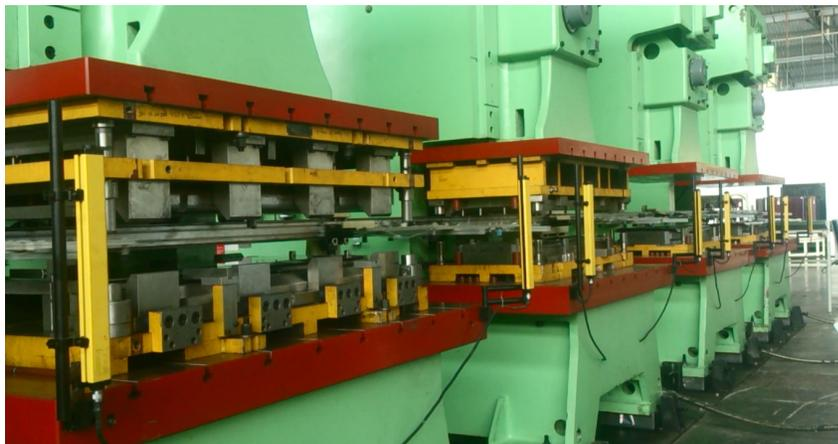
图 10 冰箱门板自动化冲压生产线
