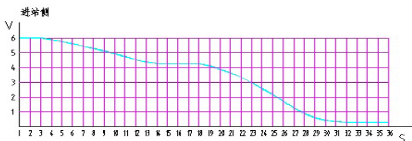
图3 吊厢进站减速的双S形速度曲线
