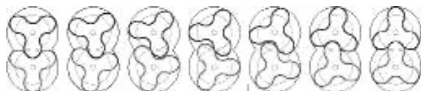
图 14 为企业新开发并投入应用的高压高性能罗茨鼓风机复合叶轮型线对滚模拟情况
