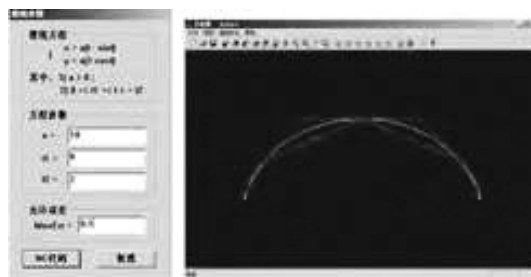
图 6 摆线方程、参数、离散及二次曲线样条生成
