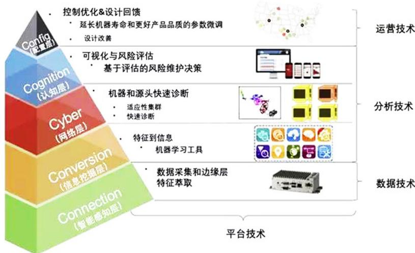
图 3 实现 CPS 制造的使能技术
