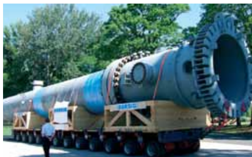
BORSIG Process Heat Exchanger GmbH - Waste Heat Boiler for Partial Oxidation 博希格过程热交换器有限公司 - 用于局部氧化的余热锅炉
