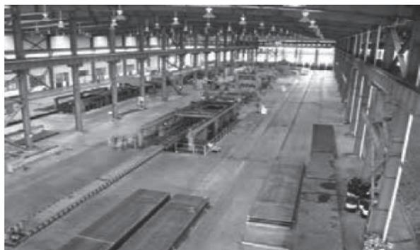
图4 25.4×3000大型超宽数控板料开卷矫平剪切生产线
