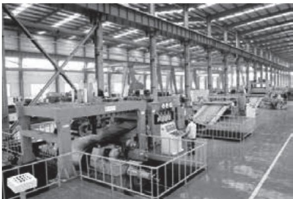
图3 系列数控板料开卷矫平移动剪切生产线
