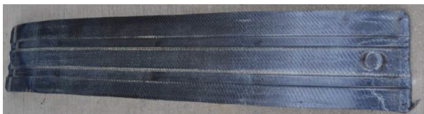
图5 热塑性碳纤维复合材料汽车防撞梁
