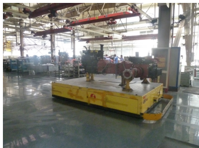
图 8 数字化装配车间底盘运输用 AGV
