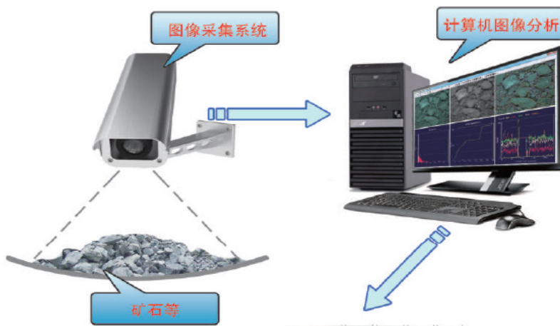
图 2 进料粒度在线监测系统
