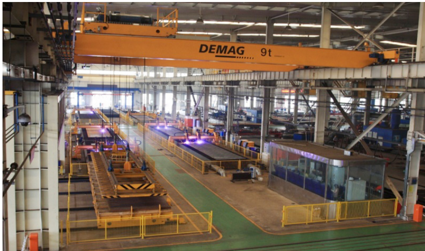
图2 全智能无人高精度切割生产线实物图
