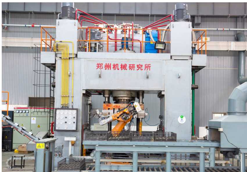
图2 数字化多方位可控流动锻造成中心
