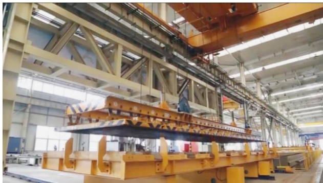
图 5 智能行车从自动交换料台吊起钢板
