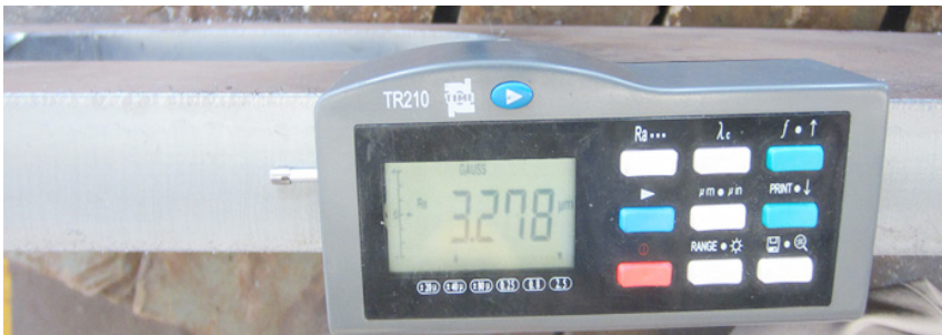
图 10 切割面表面粗糙度测量
