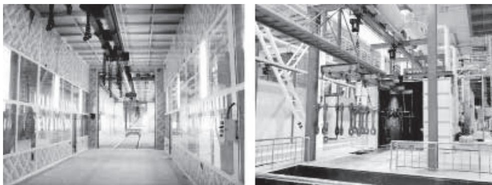
图 5 机械抛喷丸清理生产线内部输送结构
