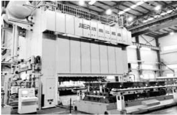
图1 出口印度冲压机器人冲压线
