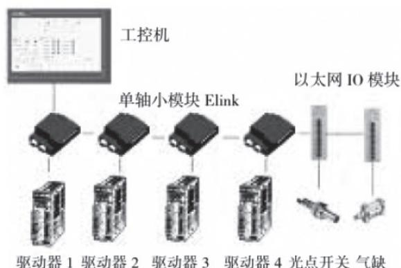
图4 码垛机械手系统结构和操作界面
