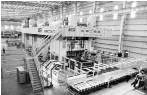
图2 LS4B-2500B 闭式四点单动多连杆压力机
