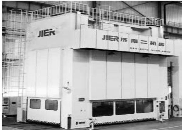
图3 25000 kN 大型伺服压力机
