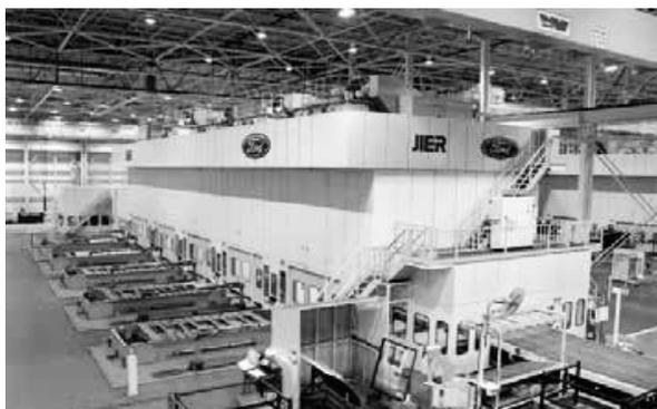
图 5 出口福特汽车公司的大型快速智能冲压生产线
