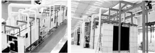
图1 工程机械抛喷丸生产成套装备
