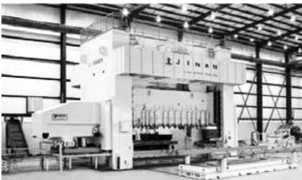
图 6 出口美国 MTD 公司的多连杆、多工位 2000t 压力机
