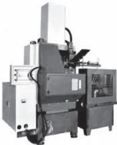
图6 数控高效径向冷挤压成形机床
