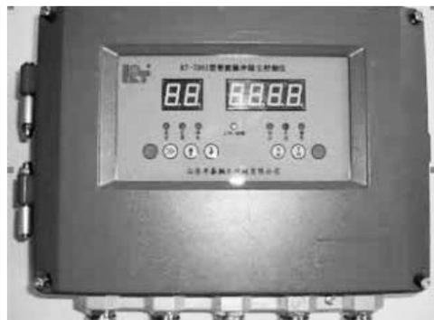
图3 KT-7001型智能脉冲除尘控制仪
