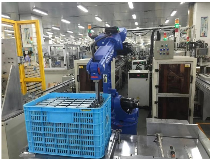
图1 工位物料的包装设计模式决定了机器人的动作和抓取方式
