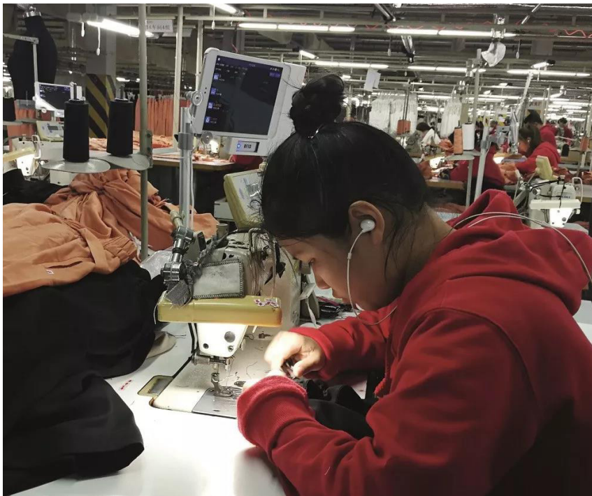
协调工人柔性工作的是一台连接在缝纫机上的智能设备。设备显示屏呈现所有服装款式的生产指令、工序步骤。摄影/《财经》记者 马霖
