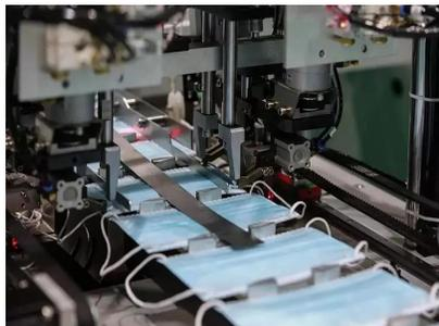
图1 航空工业研制的“1出2型”全自动口罩机
