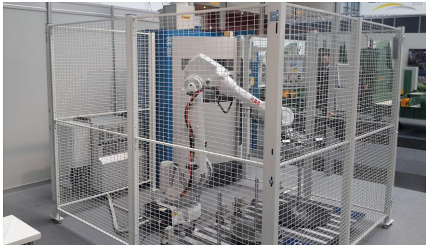
图 1 工厂车间里的自动机械臂。机器人被关在安全笼里，以确保附近人类的安全
