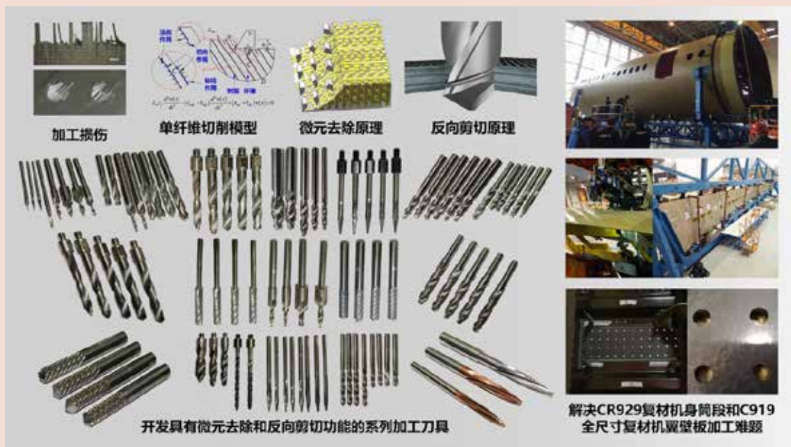
图 6 具有“微元去除”和“反向剪切”功能的复合材料系列加工工具
