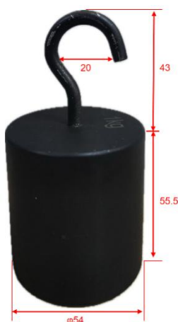
图 1 单钩砝码照片及尺寸
